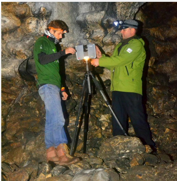
Skaner Faro Focus 3D, Jaskinia Łokietka
