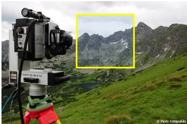
skanowanie ścian Kościelca: Profiler LPM -321 RIEGL
