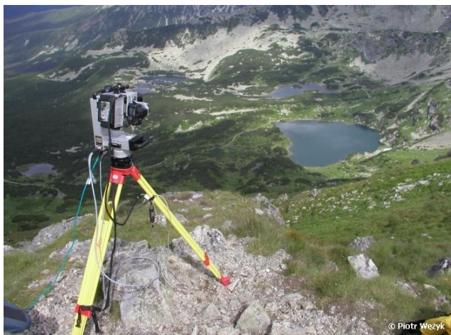
skanowanie ścian Kościelca: Profiler LPM -321 RIEGL
