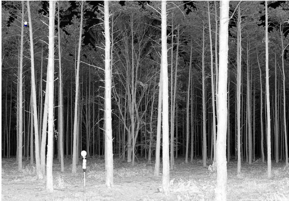
Obraz planarny 2-D (intensywność) uzyskany z jednego stanowiska pomiarowego skanera FARO LS 880
