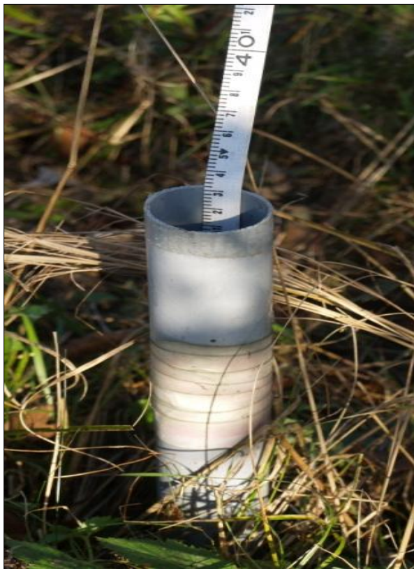
Ręczny pomiar głębokości zwierciadła wody za pomocą świstaki z taśmą mierniczą
